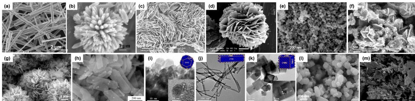
纳米氧化物气敏材料：(a-d)  $\text{ZnO}$ 、(e-g)  $\text{SnO}_2$ 、(h-k)  $\text{CeO}_2$  和 (l-m)  $\text{Co}_3\text{O}_4$ 。
